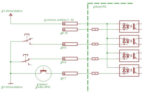
Les entrées de l'InterCNC V2.4 4 axes sont utilisables en mode source (capteur PNP) seulement (le COM est relié au 0V en interne).
