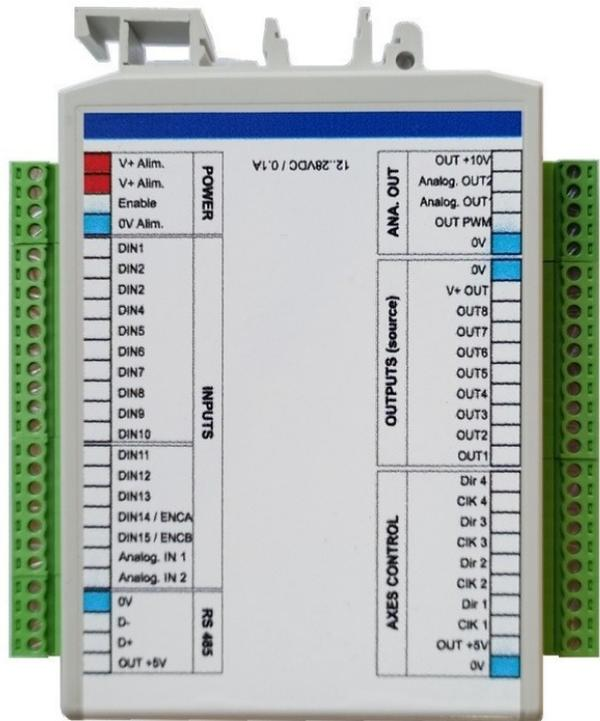
Les sorties de la carte 3 axes V2 sont de type NPN, c'est à dire qu'à l'état 1 elles tirent la tension d'alimentation (+24V) traversant la charge (bobine d'un relais, Led+résistance, etc...) vers le 0V.
