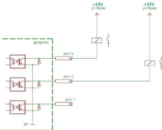
**Les sorties de la nouvelle carte 4 axes V2.4 étant de type PNP, il ne faut surtout pas appliquer une tension sur ces sorties, sous peine de destruction de celles-ci.**
