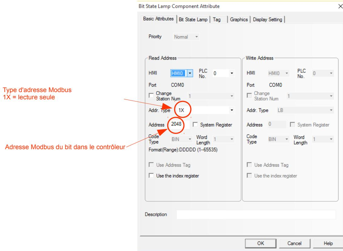
Lorsque l'on place un *Bit State Lamp* on indique le type de bit et l'adresse du bit, dans cette copie d'écran il s'agit du bit 2048 de la carte qui représente l'état de l'entrée 1.
