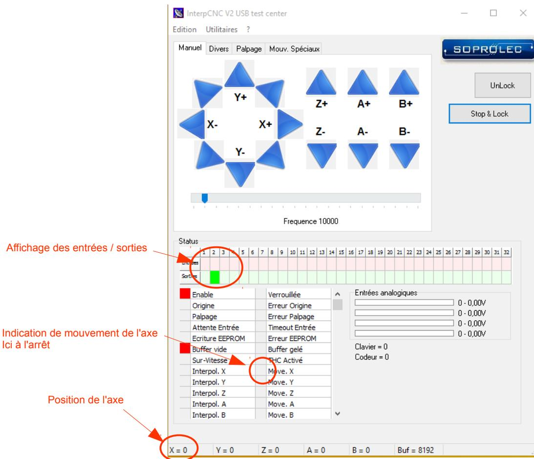
Grâce à cette fenêtre nous pouvons suivre l'état des entrées et des sorties, le déplacement ou non de l'axe, et la position de l'axe :
